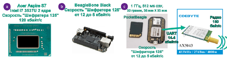
Рис. 1. Скорость шифрования на ноутбуке (а); скорость шифрования на BeagleBone Black (BeaglePocket) (б); вариант аппаратного модуля передачи данных БПЛА (с)
