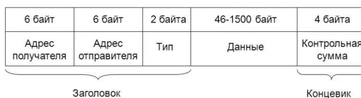
Рисунок 2.6 – Формат кадра Ethernet
