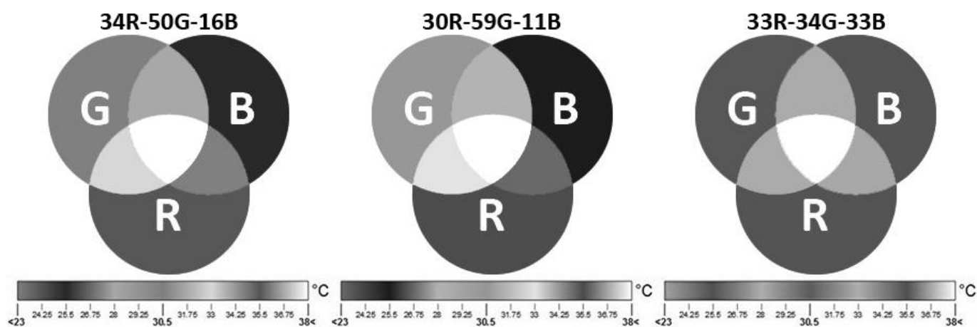
Рисунок 2.5 – Сравнение разных пропорций преобразования RGB в grayscale
