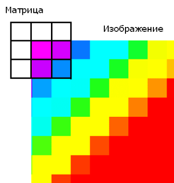
Рисунок 2.15 – Выход за предел изображения матрицы свертки
