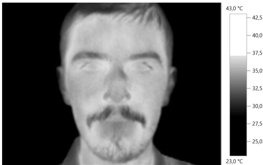
Рисунок 3.1 – Карта градиента без чередования в режиме оттенков серого. Фиксированный диапазон температур от 23 до 43 для контрастирования с любым фоном ниже 31 градуса.
