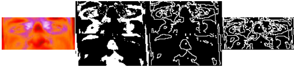
Рисунок 2.27 – Пример определения контурных признаков открытой части овала лица в два этапа
