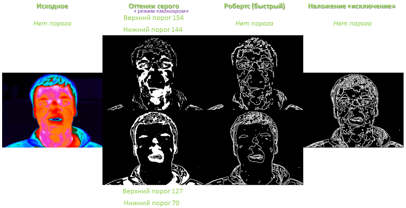
Рисунок 2.21 – Пример определения контурных признаков овала лица в два этапа
