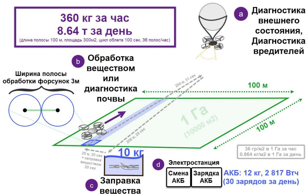
Подтверждена при помощи математического моделирования возможность стабильного полета БПЛА универсальной конструкции с прикрепленным к нему кабелем. Кроме этого, при помощи математического моделирования установлено, что БПЛА универсальной конструкции способен стабильно (сохраняя платформу параллельно земле) вытягивать вбок и поднимать вверх электрический и другие виды кабелей (шланг с реагентами), что позволяет использовать его при прокладке электросетей и обработке полей.
